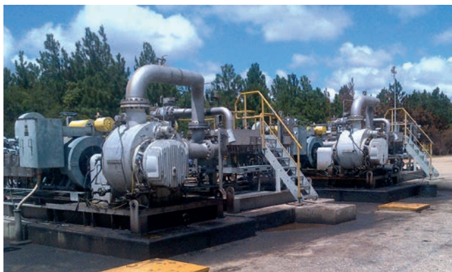
Мультифазная насосная система для многофазной среды с высоким содержанием песка
