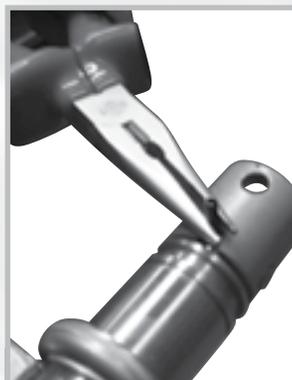
Fig. C: Montaje en eje de unión cardan
