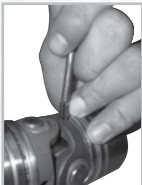
Fig. A: Armado de unión cardan.
